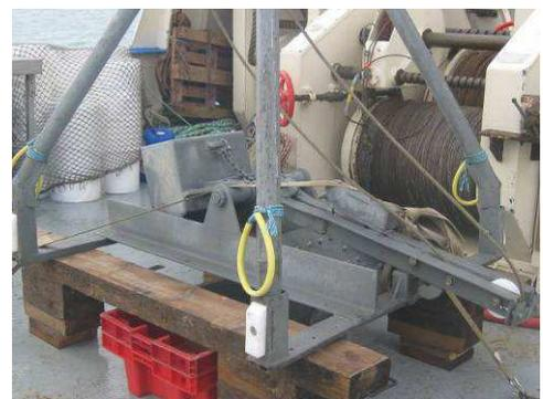
**Benne Hamon en position armée sur le pont (source : CREOCEAN)**
