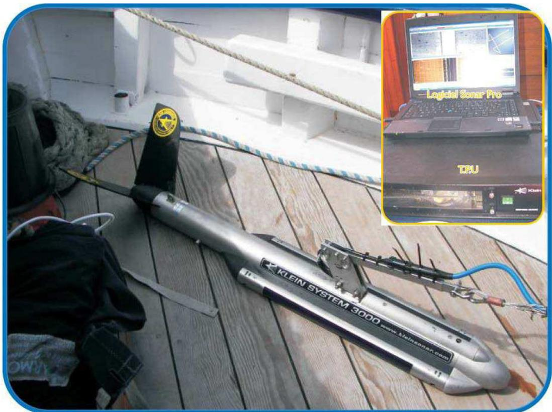
*Sonar Klein 3000 et les éléments du centre d'acquisition (source : CREOCEAN)*
